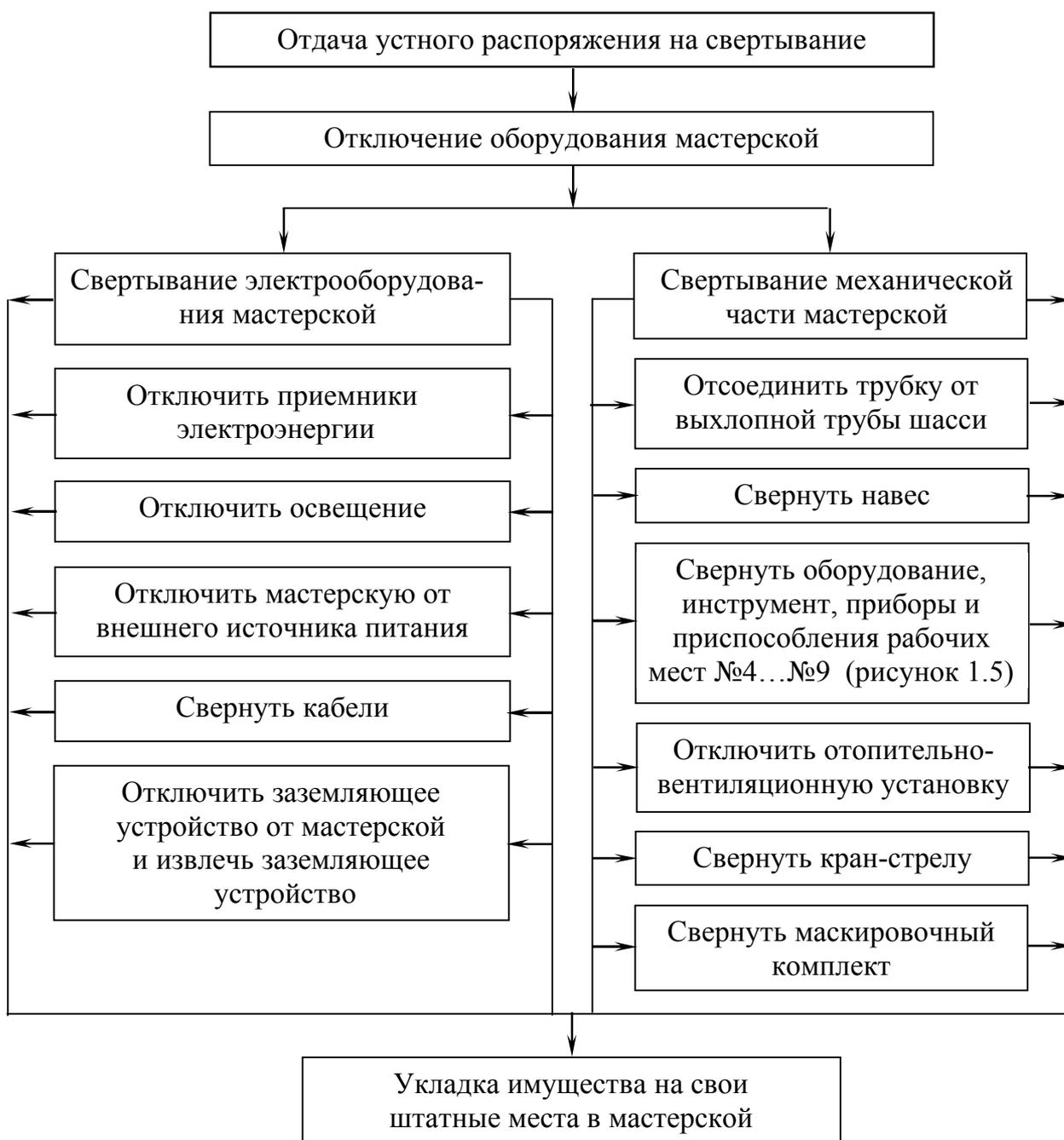
Рисунок 11.1 – Схема технологического процесса свертывания мастерской
